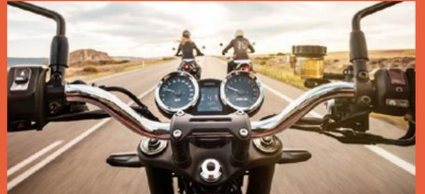
Velocímetro e conta-giros analógicos são completados por uma tela LCD multifuncional com display negativo, uniformizando o layout de letras brancas em fundo preto e equilibrando a aparência retrô com funcionalidade moderna.
