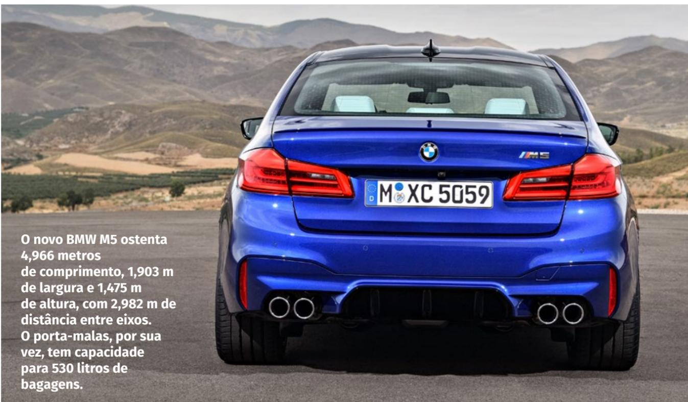
O novo BMW M5 ostenta 4,966 metros de comprimento, 1,903 m de largura e 1,475 m de altura, com 2,982 m de distância entre eixos. O porta-malas, por sua vez, tem capacidade para 530 litros de bagagens.
